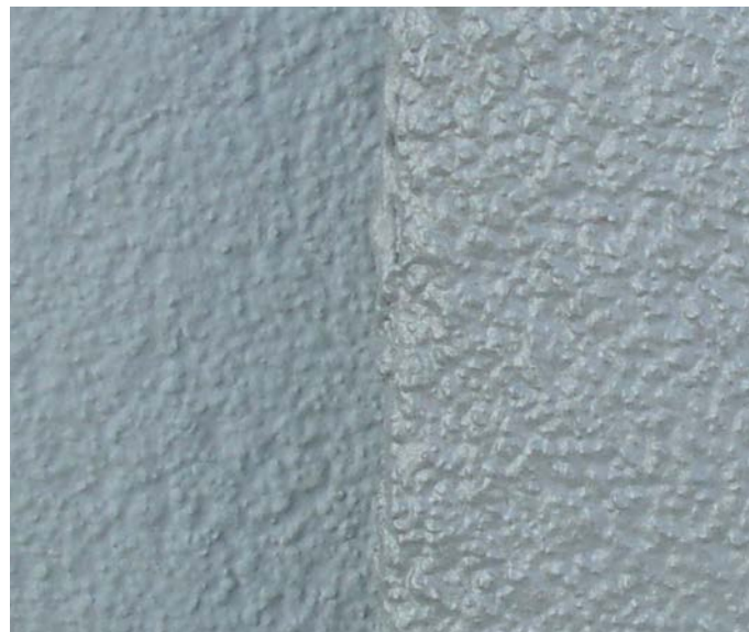
Abbildung 27. Fotografische Ansicht der Oberfläche mit einem IR-Anstrich vor (linke Seite) und nach einer Bewitterungsperiode von 12 Monaten (rechte Seite).
